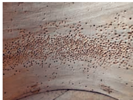
Ил. 52. Повреждение внутренней поверхности предмета из луба притворяшками. Видны многочисленные следы – выбоинки и отверстия от окукливания у верхней границы толщи зерна или муки, когда-то хранившихся в этой емкости. Фото автора
