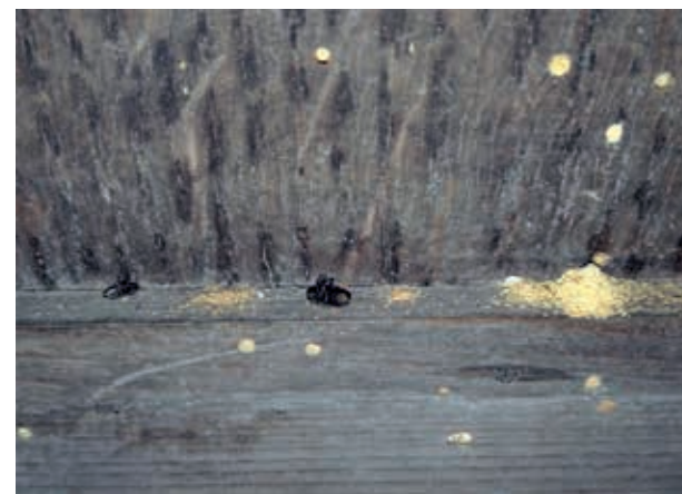
Ил. 27. Предмет мебели из дерева с активным очагом заражения мебельным точильщиком. Видны свежие летные отверстия, осыпи буровой муки, жуки точильщика (погибают через какое-то время после спаривания и откладки яиц, обнаруживаются чаще рядом с повреждаемым предметом, живут около 2 недель, иногда – до месяца и больше). Фото автора
