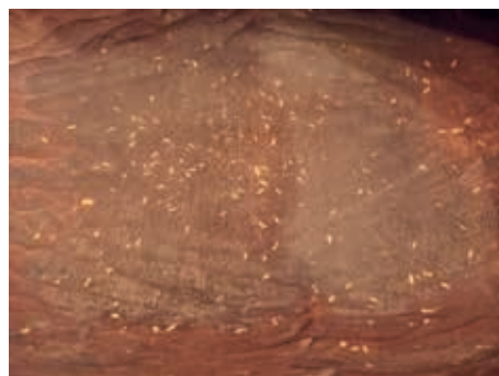
Ил. 51. Повреждение внутренней поверхности предмета из дерева (ковш) притворяшками. Видны характерные следы – выбоинки. Фото автора
