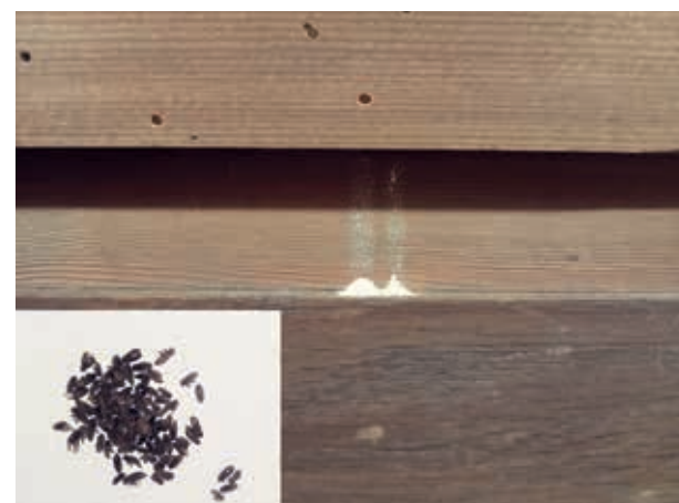
Ил. 28. Повреждение предмета мебели из дерева мебельным точильщиком: свежие летные отверстия, кучки и «струйки» буровой муки. Фото автора
