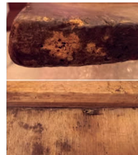
Ил. 55. Повреждение иконы притворяшками. Отверстия, причиненные при окукливании (на нижней торцевой поверхности и на задней стороне около шпонки). Фото автора
