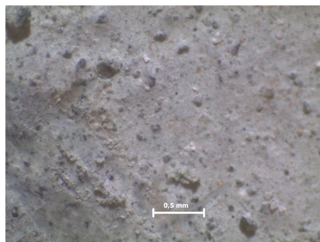
Рис.18. Красочный слой фреско- темперной живописи после обработки 3% раствором полисепта, слева, глауконит и 3% раствором катамина АБ, справа, глауконит. Видно образование пленки на поверхности красочного слоя после обработки полисептом.
