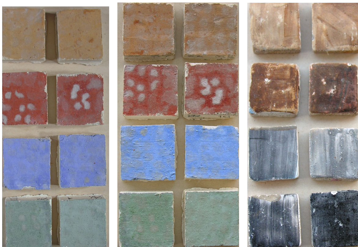
Рис.12. Слева и в центре образцы фреско- темперной живописи через 6 дней и 22 дня инкубации в условиях влажной камеры, справа, справа образцы фресковой живописи через 16 дней инкубации в условиях влажной камеры
